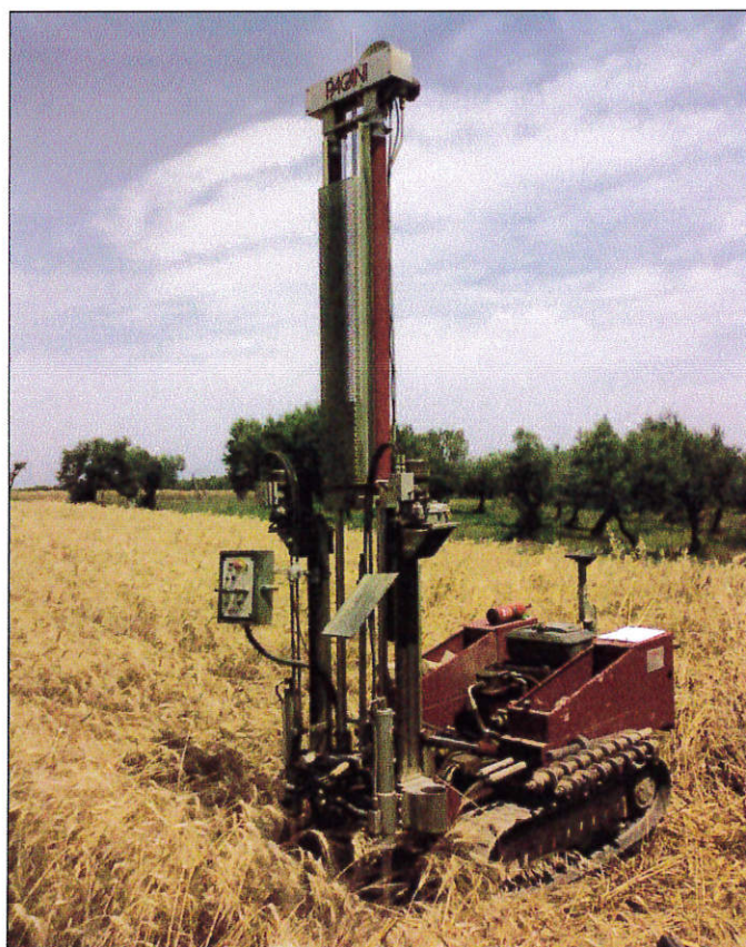
Fig.n.1 – Penetrometro statico-dinamico modello Pagani TG63-200 cingolato semovente
